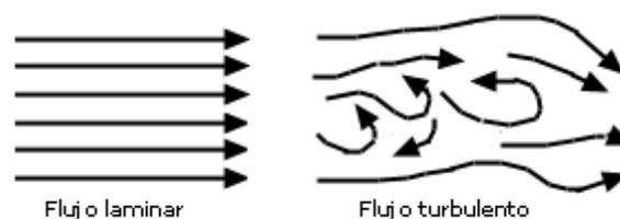
**Ilustración 5 Flujo Laminar Y Flujo Turbulento**
