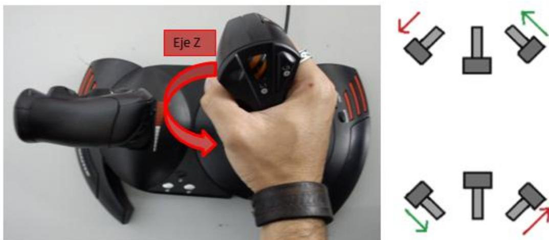
**Ilustración 53** Movimientos de motores con rotación del joystick en eje Z
