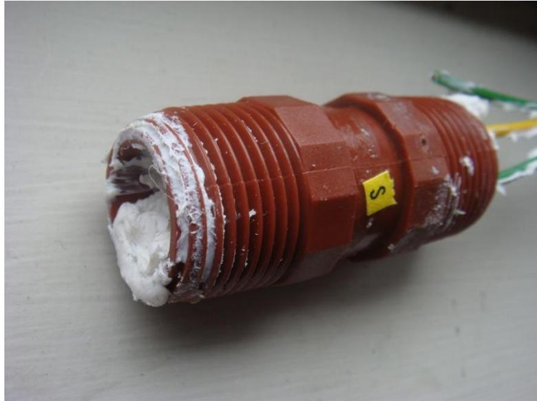
**Ilustración 33** Probeta de Abro 600 látex acrílico con silicona
