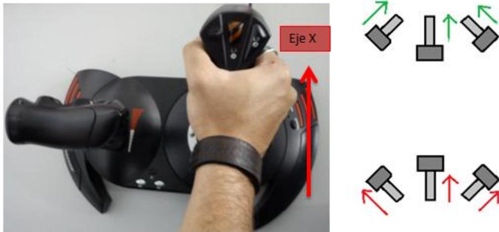
**Ilustración 52** Movimientos de motores con movimientos del eje X del joystick
