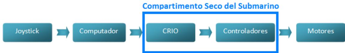
**Ilustración 18 Comunicación de los elementos de control**
