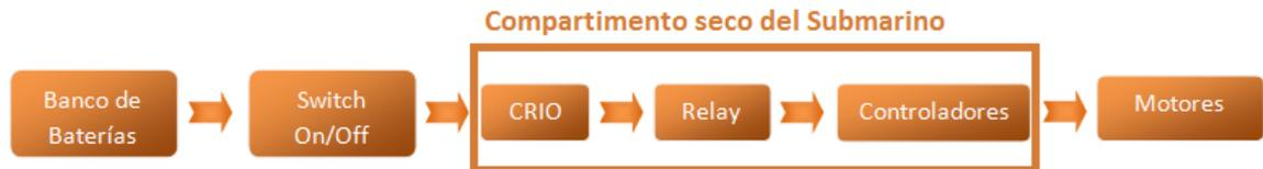
**Ilustración 19** Comunicación de elementos de potencia
