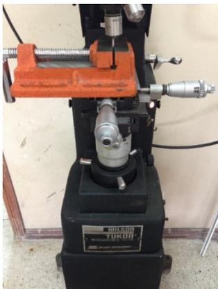
Figura 5: Fotografía de Micro durómetro marca Wilson Tukon.
