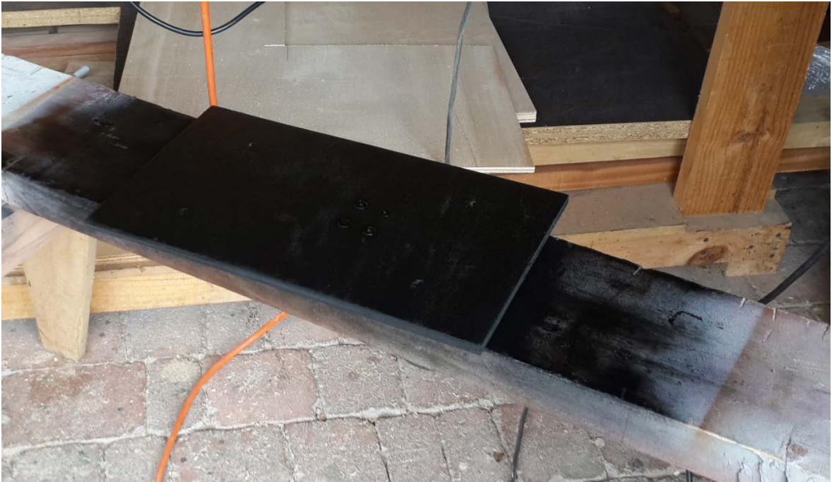
Figura Nro. 58 Base móvil con primera capa de pintura
