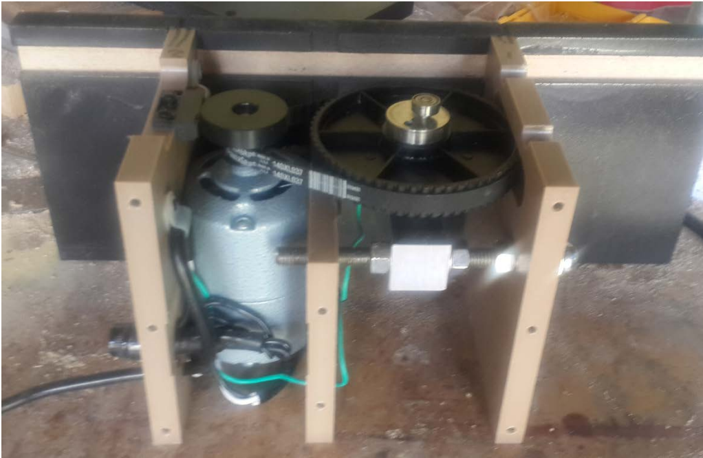
Figura Nro. 15 Vista del motor y reducción de la mesa de excitación dinámica
