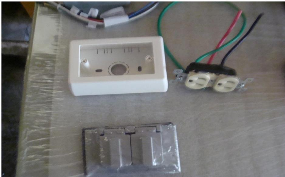
**Figura 17 Tomacorriente con acometida a tierra**
