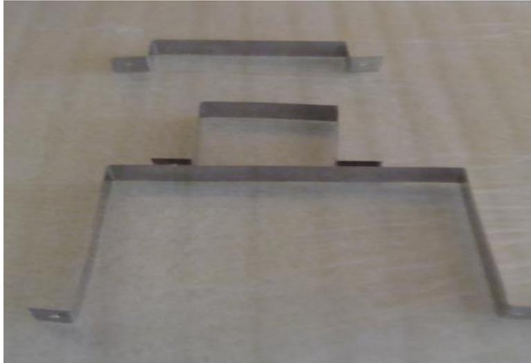
**Figura 16 Láminas para sujetar dispositivos en tablero eléctrico.**
