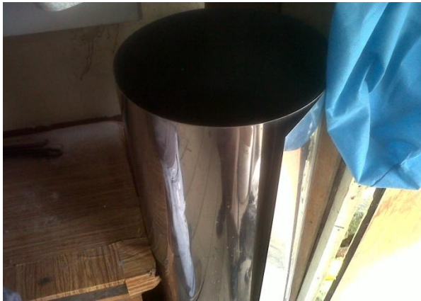
Figura 3.5. Lámina de acero inoxidable para soporte de las resistencias blindadas
