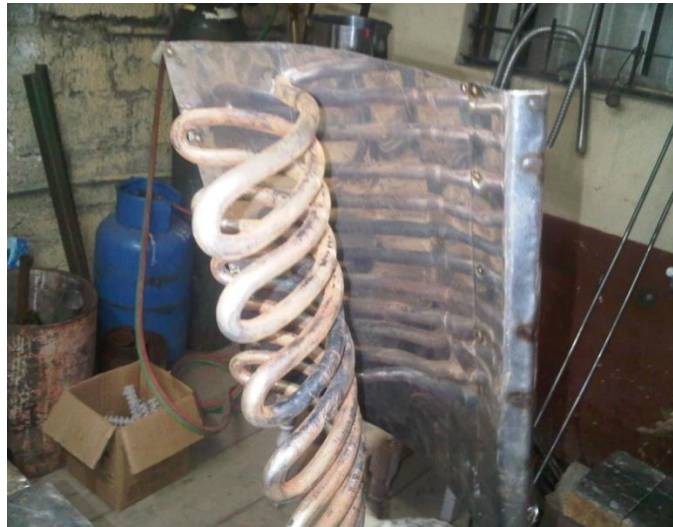
Figura 3.8. Instalación de resistencia blindada al soporte de lámina de acero inoxidable.
