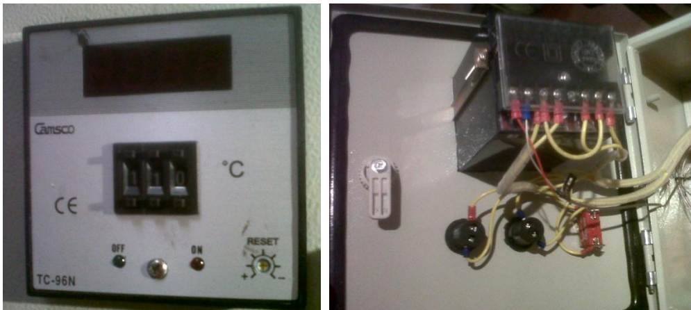
Figura 3.11. Vista por delante y por atrás del controlador ensamblado en la caja de control.
