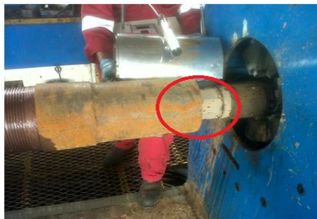
Figura 2.3. Identificación del CV coupling, elemento del motor al que se debe aplicar el calor.
