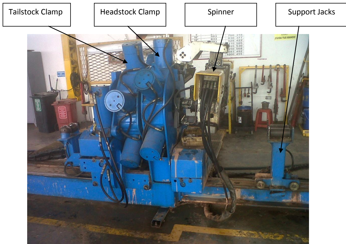
Figura 1.9. Máquina de Torque – TorqueMaster® y sus componentes principales. Vista frontal
