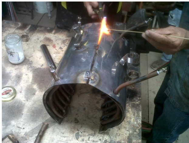
Figura 3.9. Suelda de cobre en las bisagras.
