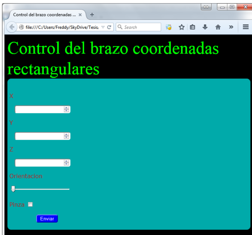
Figura 20. Interfaz web para control usando coordenadas xyz
