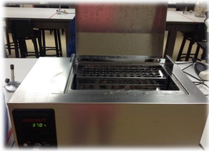
Imagen 8: Muestras colocadas en agua destilada en la máquina de baño maría a 37°C.
