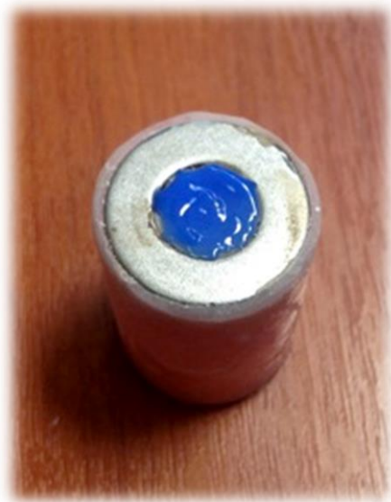
Imagen 7: Aplicación del ácido fosfórico sobre la superficie del ionómero de vidrio.
