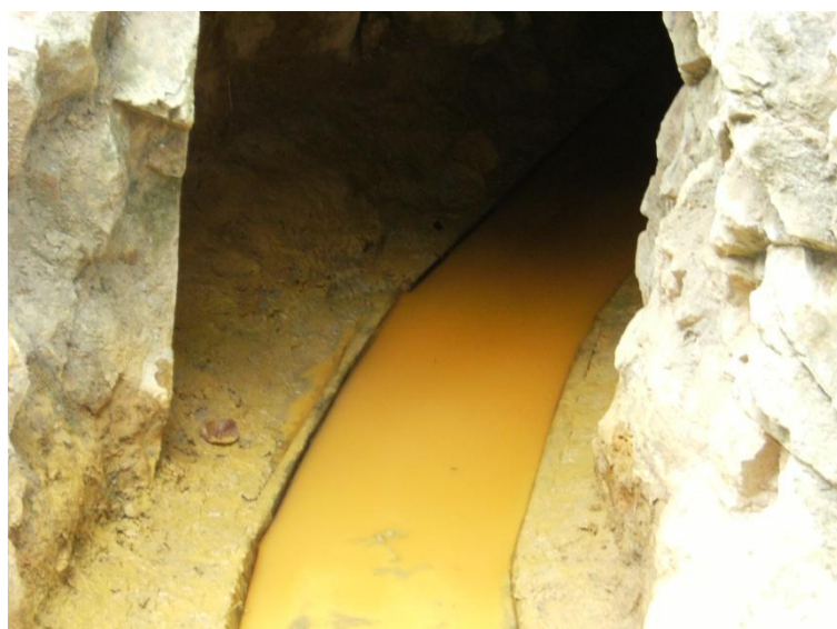
Figura 1.2: Presencia de los drenajes ácidos de mina en un túneles de extracción minera (a) en el área de Ponce Enríquez en el Distrito Minero Bella Rica y (b) en el área de Portovelo-Zaruma. Fotografías tomadas en junio del 2009 durante una visita de campo a los distritos mineros en cuestión.
