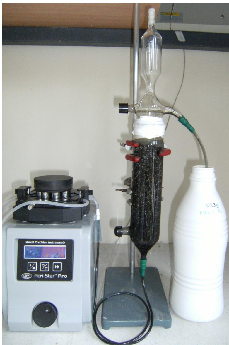
Figura 3.4: Foto del bioreactor empleado durante la sulfato-reducción microbiana. El bioreactor fue alimentado con una muestra sintética formada por acetato ( 2.5 \text{ g DQO L}^{-1} ), sulfato ( 4000 \text{ mg L}^{-1} ) y el medio basal, y empacado con 15 \text{ g SVS L}^{-1} de los sedimentos de la laguna artificial de la USFQ soportados en arena en un modo de operación continuo con un flujo ascendente.
