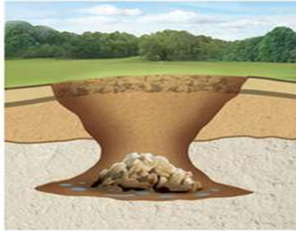
Figura 10, Hundimiento por subsidencia (USGS, 2004).
