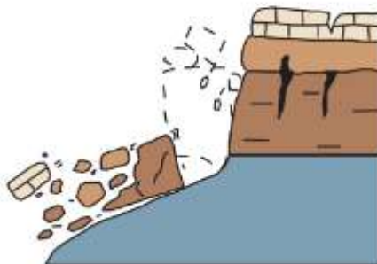
Figura 7, Volcamiento de roca (USGS, 2004).
