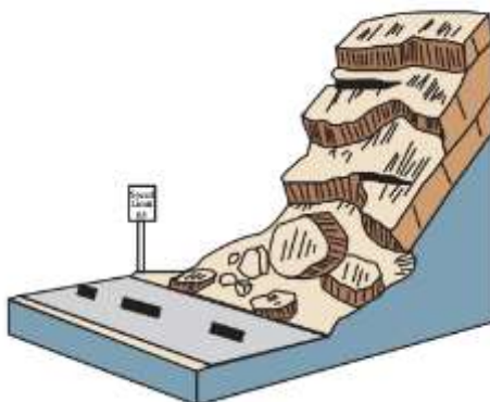
Figura 5, Caída de escombros (USGS, 2004).
