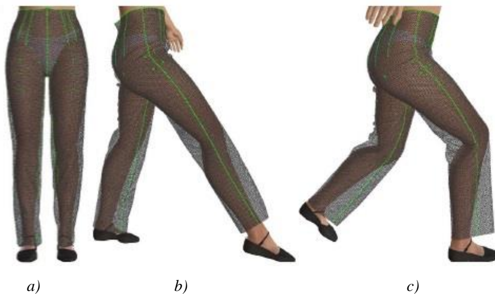
Sl. 71 Položaji tijela u kojima je izvedeno utvrđivanje vrijednosti naprežanja i istežanja simulirane tkanine na modelima hlača: a) statički položaj, b) dinamički položaj tijela 1, c) dinamički položaj tijela 2
