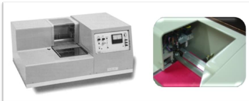
Sl.6 KES-FB2 AUTO mjernom sustav za savojna svojstva[7]
