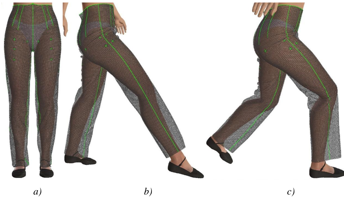
Sl. 58 Položaji tijela u kojima je izvedeno utvrđivanje vrijednosti naprezanja i istezanja simulirane tkanine na modelima hlača: a) statički položaj, b) dinamički položaj tijela 1, c) dinamički položaj tijela 2
