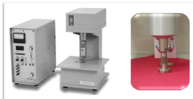
Sl.8 KES-FB3 AUTO mjerni sustav za kompresijska svojstva [7]
