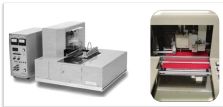
Sl.9 KES-FB4 AUTO mjerni sustav za površinska svojstva [7]
