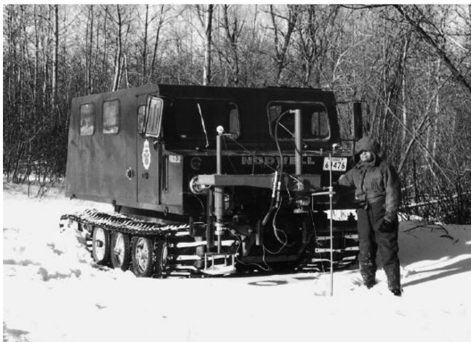
Figura 2.61: Un bevameter montato su di un veicolo per la misurazione delle proprietà del terreno sul campo
