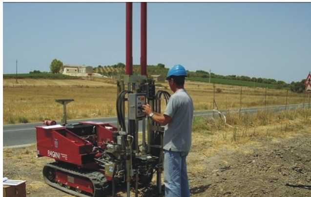
Figura 2.58: Prova penetrometrica statica con penetrometro semovente
