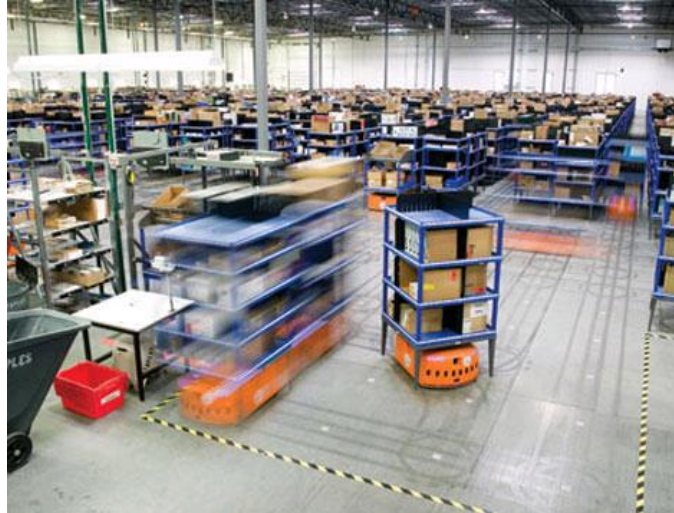
Figura 2.44: Robot scaffali che si spostano autonomamente seguendo il percorso rappresentato sul terreno
