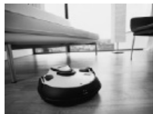
Figura 2.10: BR 700 robot per le pulizie industriali (a sinistra) e il RoboCleaner RC 3000. Il sistema di navigazione del BR 700 è basato su di un sistema sonar molto sofisticato. Il RoboCleaner RC 3000 copre aree molto sporche con una strategia di guida che si conclude quando queste aree vengono pulite definitivamente. Sensori ottici misurano il grado di inquinamento dell'aria aspirata ( http://www.karcher.de ). ©Alfred Kärcher GmbH & Co.
