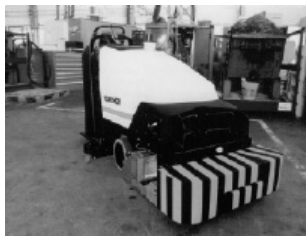
Figura 2.10: BR 700 robot per le pulizie industriali (a sinistra) e il RoboCleaner RC 3000. Il sistema di navigazione del BR 700 è basato su di un sistema sonar molto sofisticato. Il RoboCleaner RC 3000 copre aree molto sporche con una strategia di guida che si conclude quando queste aree vengono pulite definitivamente. Sensori ottici misurano il grado di inquinamento dell'aria aspirata ( http://www.karcher.de ). ©Alfred Kärcher GmbH & Co.
