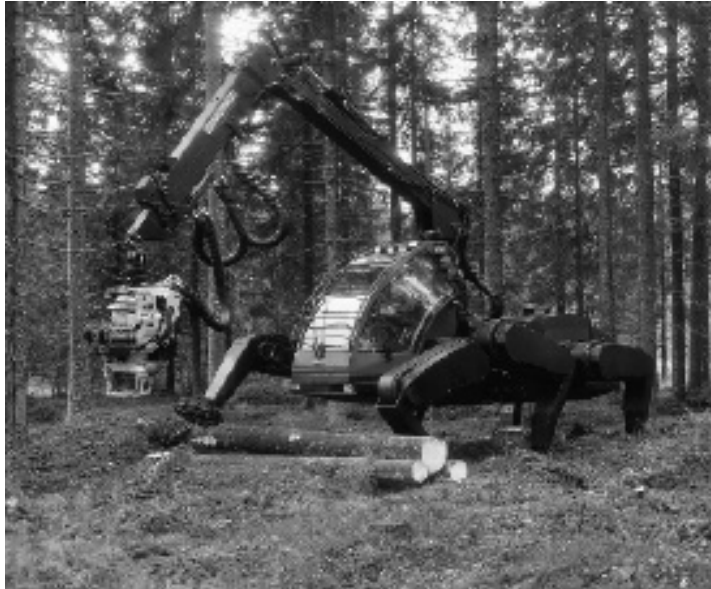
Figura 2.3: Plustech ha sviluppato alcuni dei primi modelli di robot su gambe. Esso è progettato per trasportare legna attraverso la foresta. Il coordinamento delle gambe è automatizzato, ma la navigazione è ancora coordinata dall'operatore umano. ( http://www.plustech.fi ). ©Plustech.
