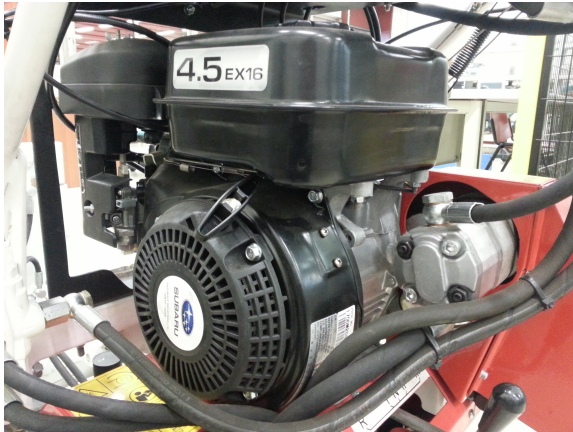
Figura 6.2: Motore monocilindrico, a benzina, a 4 tempi, raffreddato ad aria SUBARU
