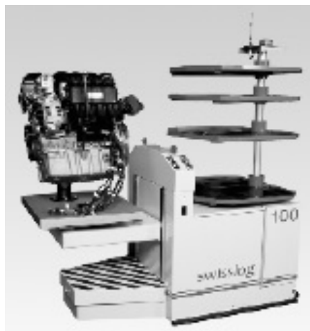
Figura 2.8: Nuova generazione di veicolo autonomo (AGV) di Swisslog usato per trasportare i blocchi motore da una stazione di montaggio ad un altro. È guidato da un filo elettrico installato nel pavimento. Esistono migliaia di AGV impiegati per il trasporto di prodotti nel settore industriale, magazzini, e persino negli ospedali. ©Swisslog.
