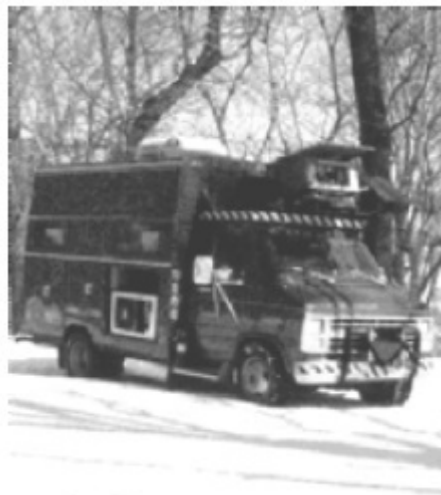
Figura 2.30: Navlab I, il primo veicolo autostradale autonomo che controlla la direzione e l'acceleratore tramite telecamere e sensori radar[61]. Sviluppato da CMU.
