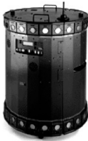
Figura 2.35: Il Nomad XR4000 della Nomadic Technologies a quattro ruote basculanti per il movimento oloonomo. Tutte le ruote sono sterzanti e di trazione, richiedendo quindi una sincronizzazione e coordinamento preciso per ottenere un movimento preciso in x , y e \theta .
