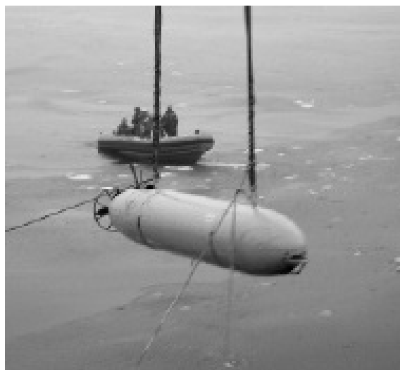
Figura 2.6: Immagine del recupero del MBARI ALTEX AUV (Autonomous Underwater Vehicle) sul rompighiaccio Healy a seguito di una immersione sotto il ghiaccio artico. Todd Walsh ©2001 MBARI.
