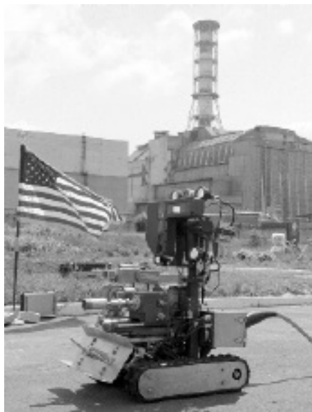
Figura 2.5: Immagine di Pioneer, un robot progettato per esplorare il sarcofago di Chernobyl. ©Wide World Photos.
