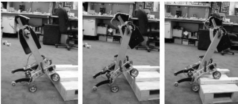
Figura 2.38: Il Personal Rover, capace di arrampicarsi grazie allo spostamento attivo del centro di massa.
