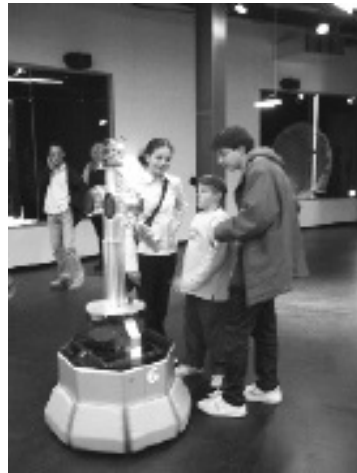
Figura 2.7: Robot guida turistica in grado di interagire e presentare mostre in modo educativo [48, 118, 132, 143,]. Dieci Roboxes hanno operato per cinque mesi alla fiera svizzera EXPO.02, incontrando centinaia di migliaia di visitatori. Essi sono stati sviluppati da EPFL [132] ( http://robotics.epfl.ch ) e commercializzati da BlueBotics ( http://www.bluebotics.ch ).
