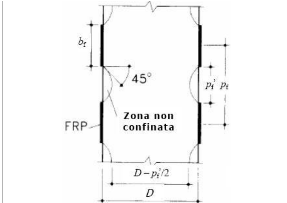
Fig. 3.70 –Coefficiente di efficacia verticale [3.118]
