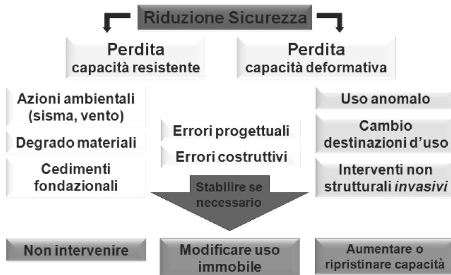
Fig. 2.1 – Diagramma di flusso per il progetto degli interventi [2.33]
