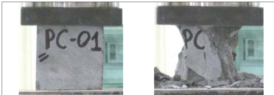
Fig. 4.17 – Prove di compressione sulla pietra calcarea (a) provino nel corso della prova, (b) campione al termine della prova.
