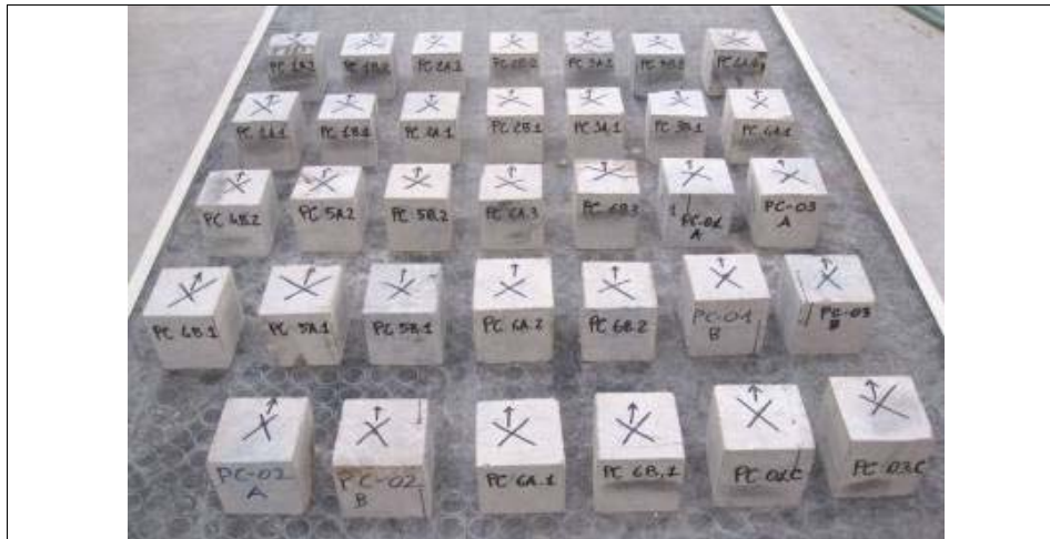
Fig. 4.16 – I provini di pietra calcarea sottoposto a prova di compressione
