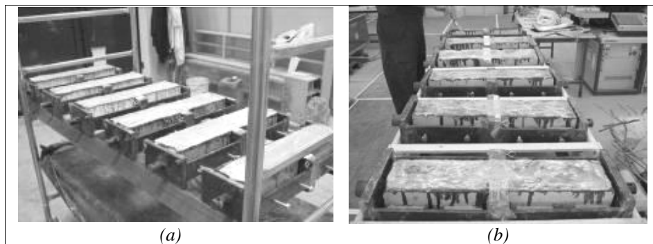
Fig. 4.25 – Preparazione di alcune delle prove di aderenza (a) provini in tufo rinforzati con C-FRP e G-FRP; (b) provini in pietra calcarea rinforzati con G-FRP e C-FRP.
