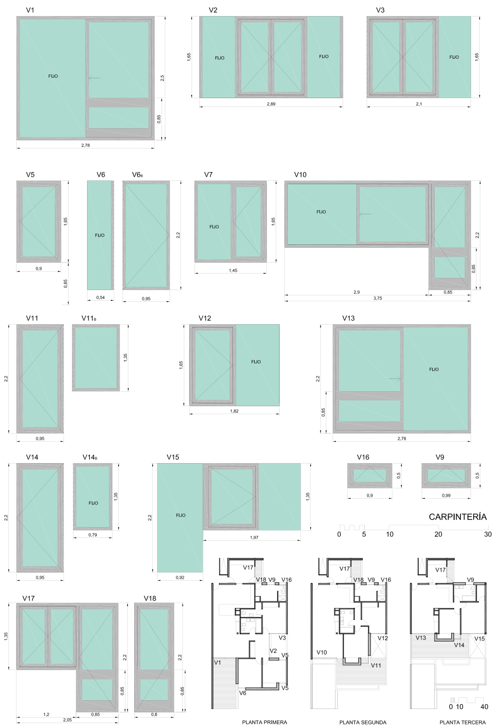
Figura 3.10.16 Carpintería de las tres viviendas del edificio escalonado Babilonia, realizado por el autor tras examinar el proyecto y el edificio existente. Fuente: elaboración propia
