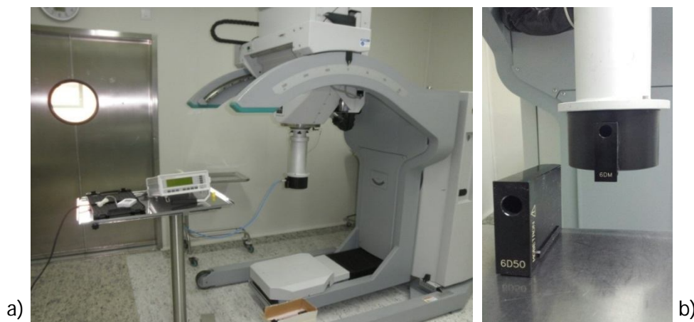
Fig.11. (a) Dispositivo experimental para la realización del control de calidad. (b) Detalle de los insertos en el aplicador.
