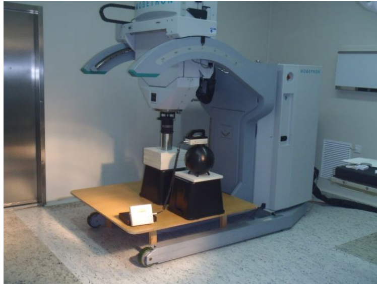
Fig.18. Dispositivo experimental para la medida de dosis de neutrones.
