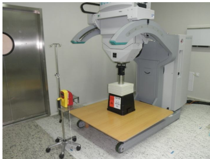
Fig.15. Dispositivo experimental para la medida de dosis área sin barreras estructurales.
