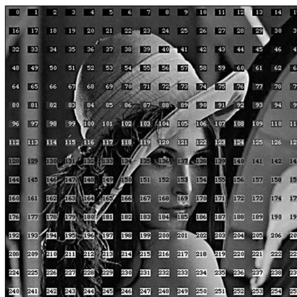
Figura 3. Intensidades de gris en una imagen de 8 bit (256 niveles de gris).
