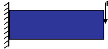
Şekil 1. Tasarım alanı, yük ve sınır şartları
