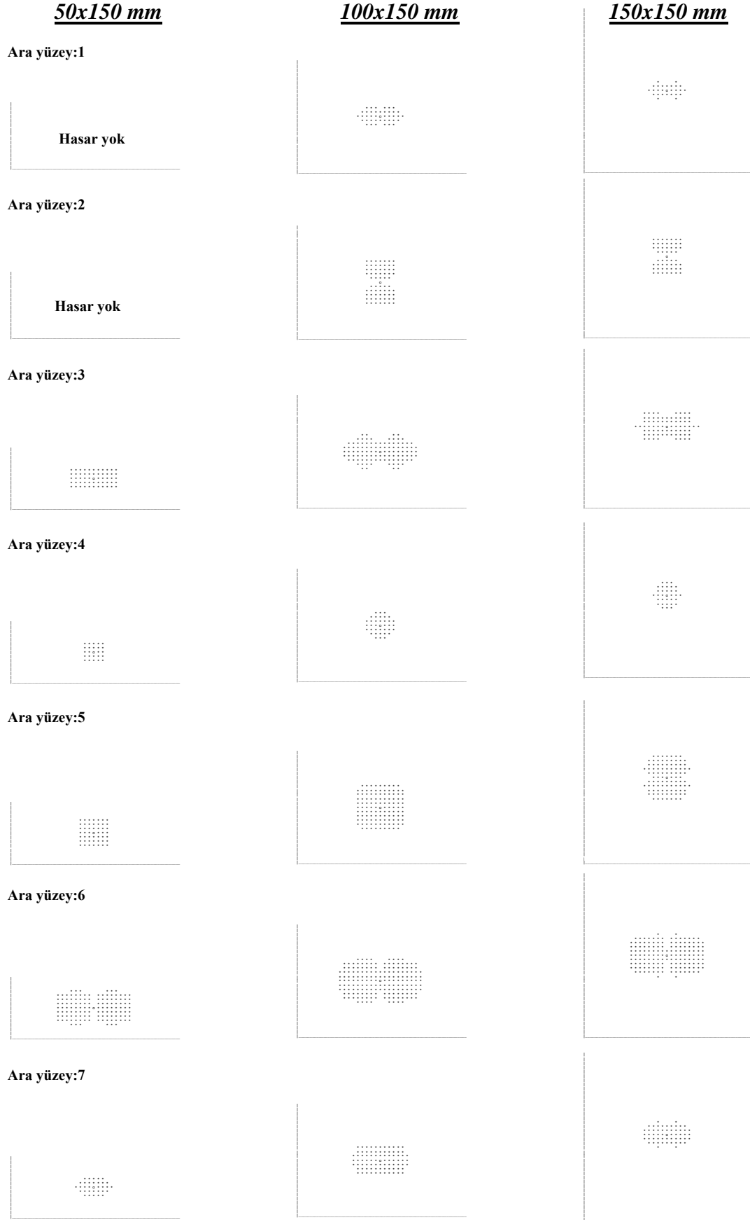
Şekil.13 Farklı boyutlar için delamination hasarı (m=2600 g, 3 m/sn).
