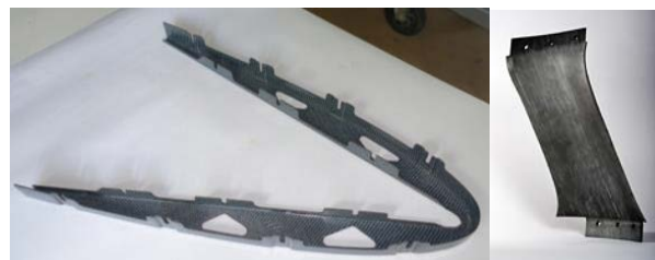
BILD 4. li. gepresste Rippe aus CF-PEEK; re. CF-PEEK Leitgitter
