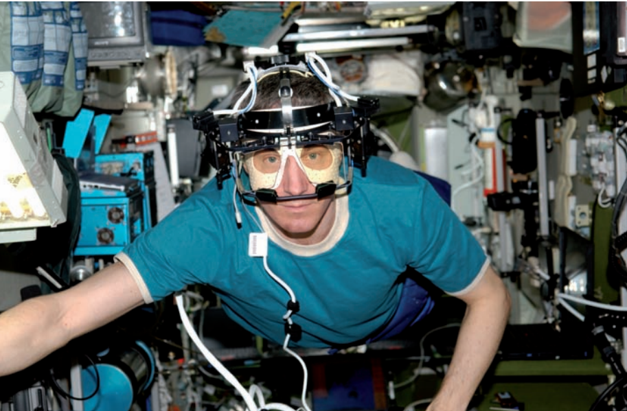
Kosmonaut mit mobilem Eye Tracking Device (ETD) 2009 auf der internationalen Raumstation ISS.
