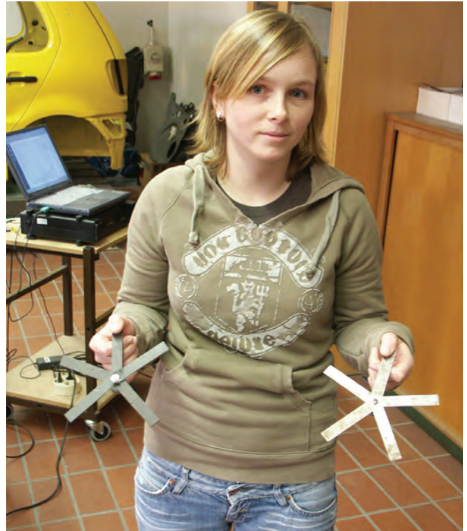
Katharina Kompe präsentiert links den neue Breitbandresonator mit der grauen Spezialbeschichtung und rechts sein Vorgängermodell.
