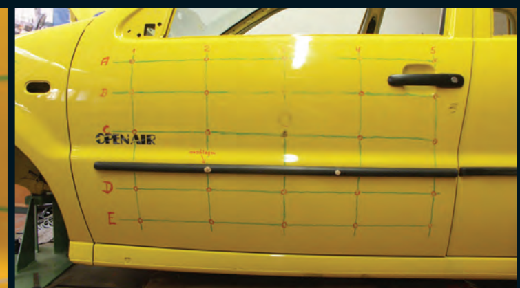
Versuchsobjekt: An dem gelben Polo haben Dortmunder Studierende unter Borcherts Leitung die Funktionsweise von Resonatoren getestet.
