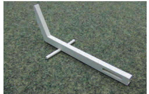
Vor der Gewichtoptimierung ist der Rahmen des eLTec massiv und schwerer als nötig
