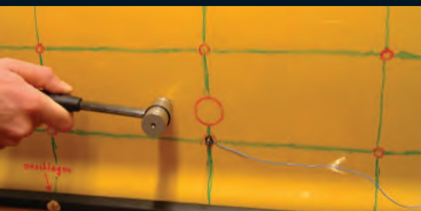
Durch einen Hammerschlag bringt man die Autotür zum Vibrieren und misst deren Schwingungsfrequenz.
