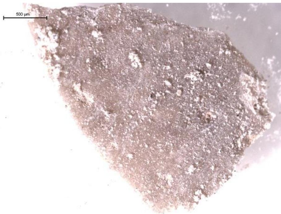
**Figura V.2.1.2.1.4. Microfotografía obtenida con luz especular reflejada de la muestra 2.1 extraída de la capa de corrosión de la escultura “Crónica del viento” (25x).**
