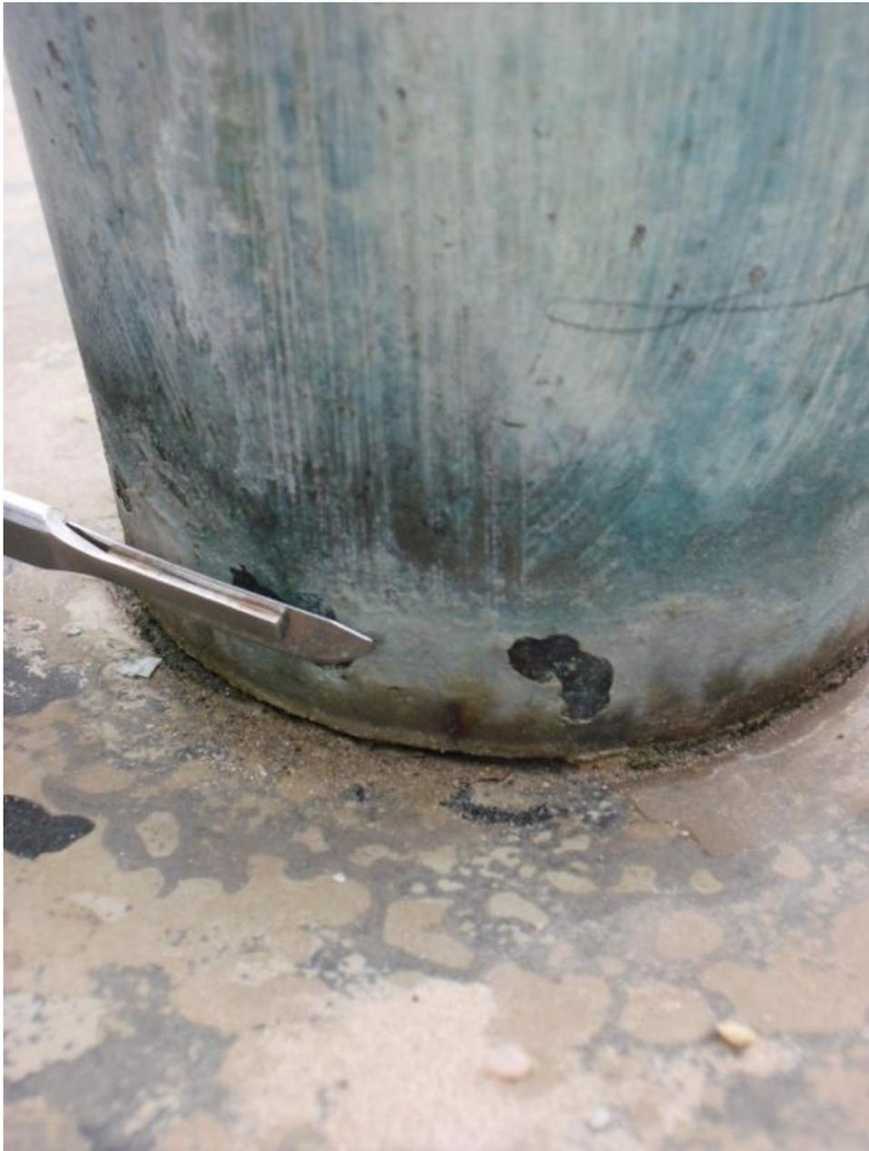
**Figura IV.2.1.3.3. Extracción de la muestra 3.1.**
