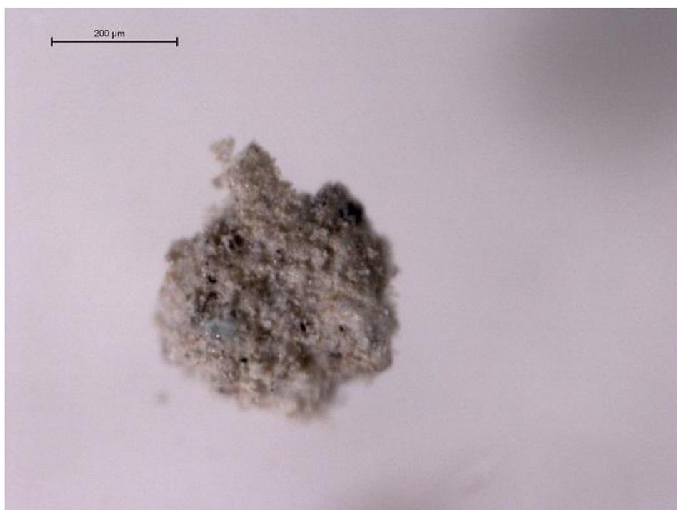
Figura V.2.1.4.1.1. Microfotografía obtenida con luz especular reflejada de la muestra 4.1 extraída de la capa de corrosión de la escultura “El estudio” (80x).
