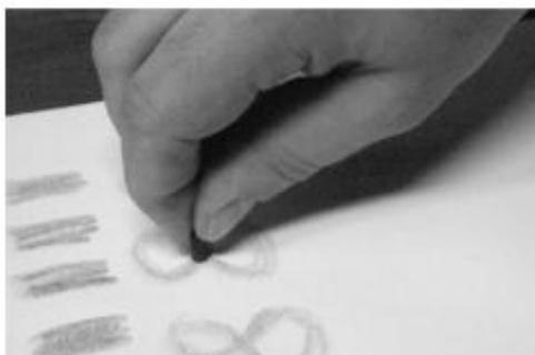
**Figura III.4.2.3.1. Limpieza de un electrodo de grafito impregnado con parafina mediante el pulido continuo sobre papel [Scholz *et al.*, 2014].**
