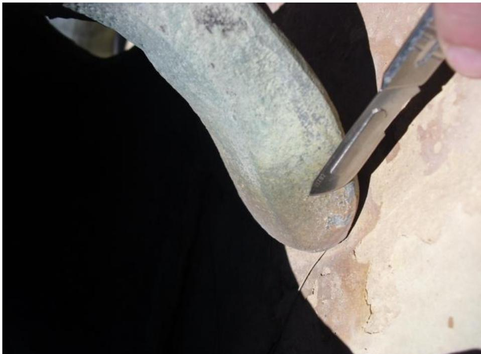
**Figura IV.2.1.5.7. Extracción de la muestra 5.4.**
