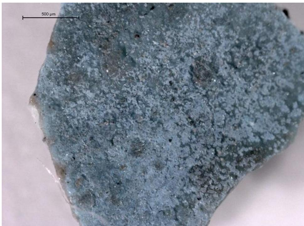
Figura V.2.1.3.1.1. Microfotografía obtenida con luz especular reflejada de la muestra 3.1, extraída de la capa de corrosión de la escultura "Alegoría de la mujer", tomada mediante microscopía óptica (32x).
