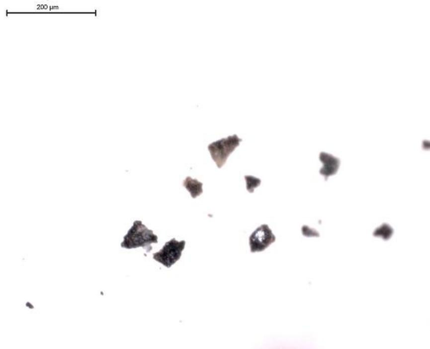
Figura V.2.1.5.1.5. Microfotografía obtenida con luz especular reflejada de la muestra 5.3 extraída de la escultura “Gades, la danza 2001” (80x).
