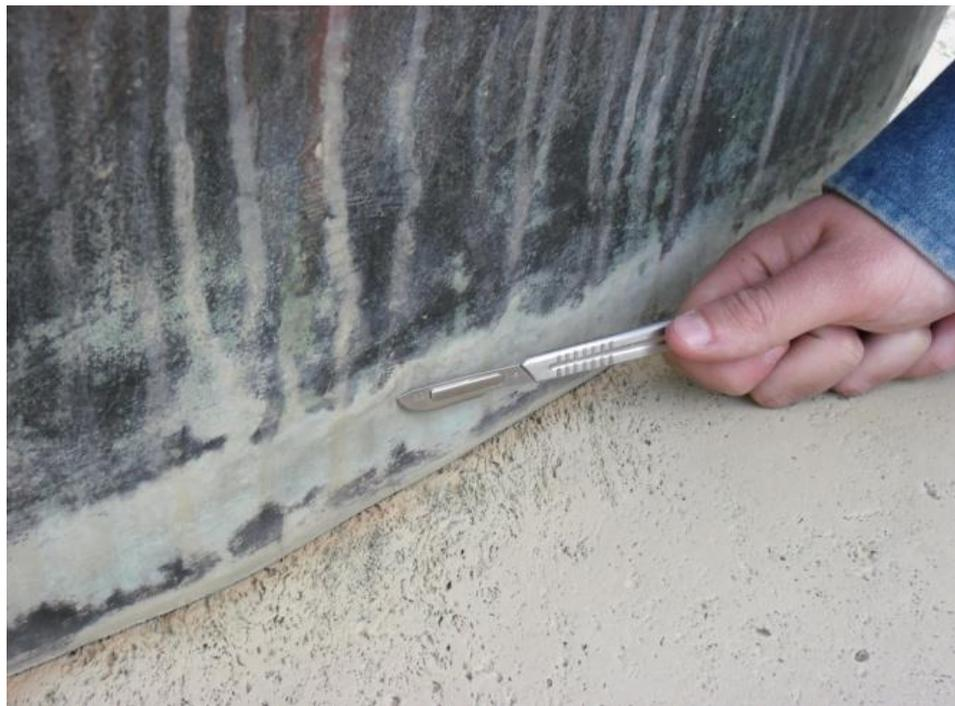
Figura IV.2.1.7.3. Extracción de la muestra 7.1.
