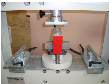
Slika 7 - Ispitivanje vlačne čvrstoće morta
