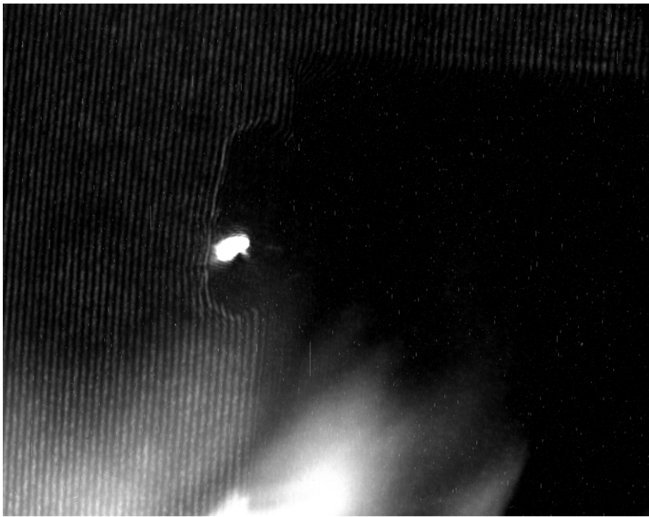
Figura 4.12: Immagini relative all'interferometria dello sparo 54 acquisita 1.2ns dopo l'inizio dell'interazione tra il fascio 1 e il bersaglio. Si notano le linee di interferenza curvate rispetto alle fasi antecedenti lo sparo.
