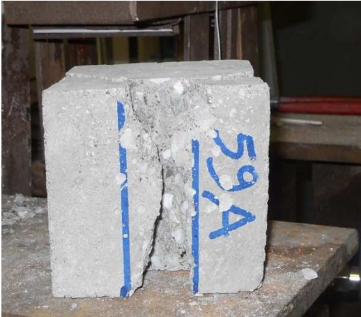
Figura 31: Cls- rottura prova di compressione modificata
