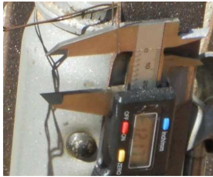
Figura 22: Calibro digitale centesimale
