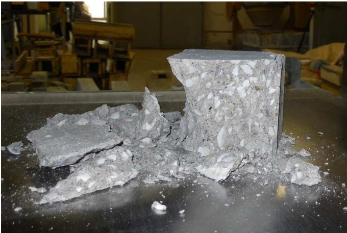
Figura 28: Cls- prova di compressione - rottura provino
