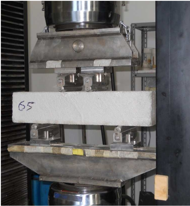
Figura 25: Calcestruzzo-prova di flessione con strumentazione di laboratorio
