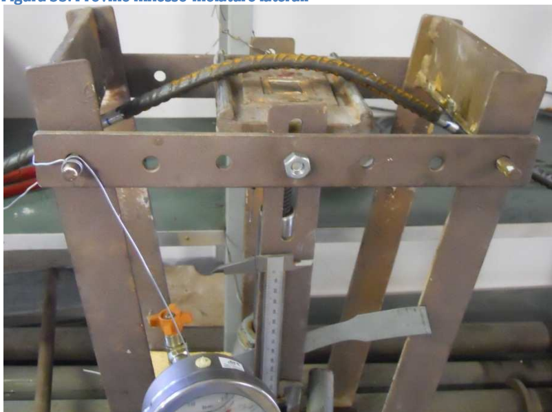
Figura 34: Acciaio-prova di flessione
