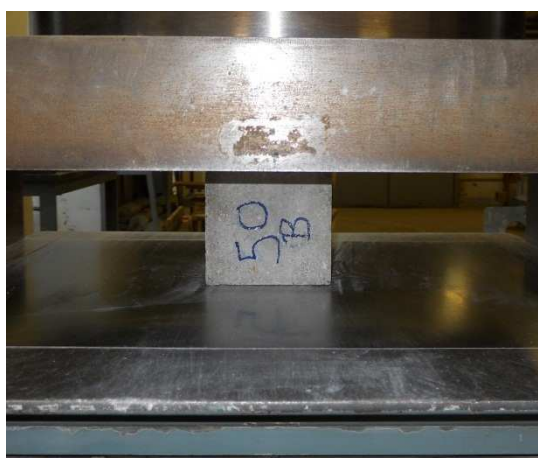
Figura 27: Cls- prova di compressione standard
