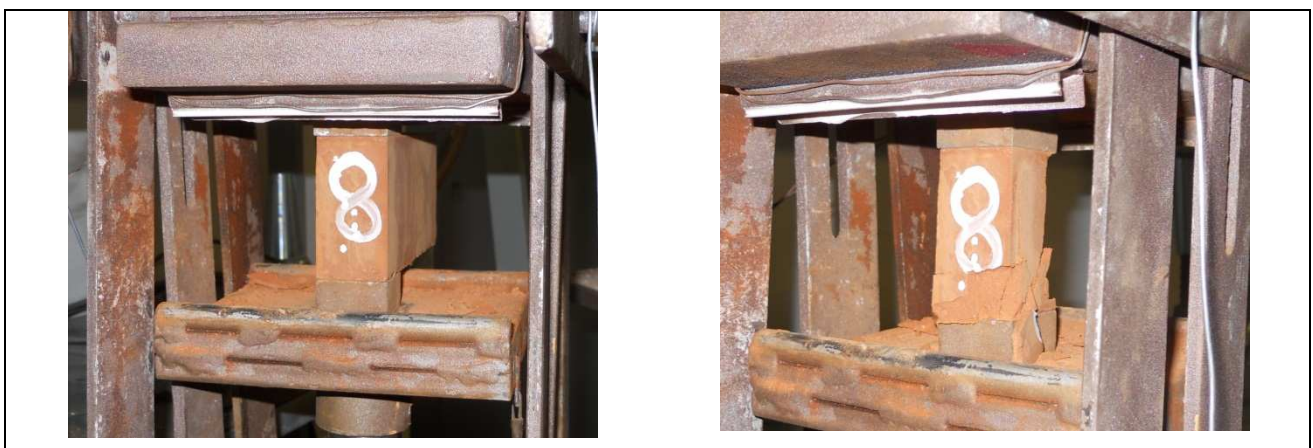
Figura 39: Laterizio-prova di indentazione con DPP
