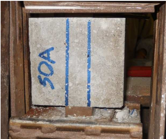
Figura 30: Cls- prova di compressione modificata su DPP
