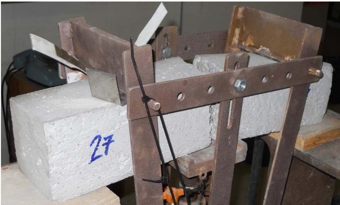
Figura 24: Calcestruzzo-rottura provino a trazione per flessione DPP
