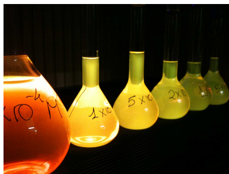
Figura 2.23: Soluzioni di N,N' -bis-(6-essanolo)-3,4,9,10-perilene tetracarbossi-diimmide a diverse concentrazioni in \text{CHCl}_3/\text{TFA} , sotto la luce di una lampada UV a \lambda = 366 \text{ nm} .
