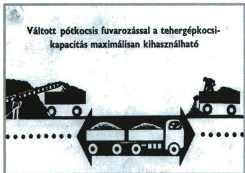
12. ábra A TEHERGÉPKOCSIK ÉS A PÓTKOCSIK JOBB KIHASZNÁLÁSÁT VÁLTOTT PÓTKOCSIS FUVAROZÁSSAL IS SZERETTÉK VOLNA MEGJAVÍTANI
