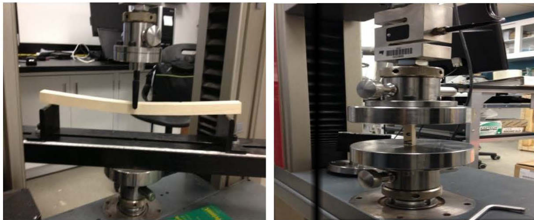
Figure 2.3 (a) Test de flexion trois points et de compression parallèle (b) à l'aide de l'appareil d'essai universel Zwick/Roell Z20.
