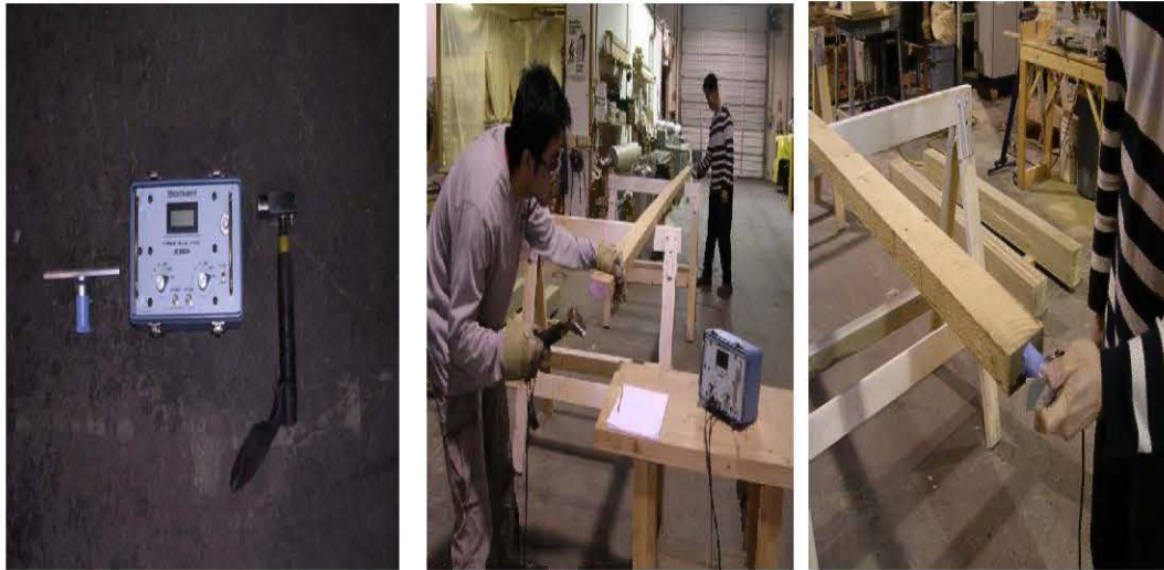
Figure 1.6 Mesure de temps de propagation par le système Metriguard, modèle 239A (Zaturecky et al. , 2006).
