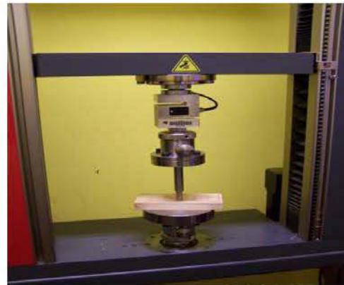
d. Banc d'essai pour la mesure de la dureté (ASTM-D143)
