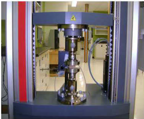
c. Banc d'essai pour la mesure de la résistance en compression perpendiculaire au fil (ASTM-D143)
