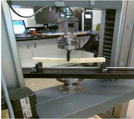
a. Banc d'essai pour les mesures du MOE et du MOR en flexion (ASTM-D143)
