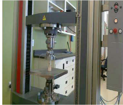
b. Banc d'essai pour la mesure de la résistance en compression parallèle au fil (ASTM-D143)
