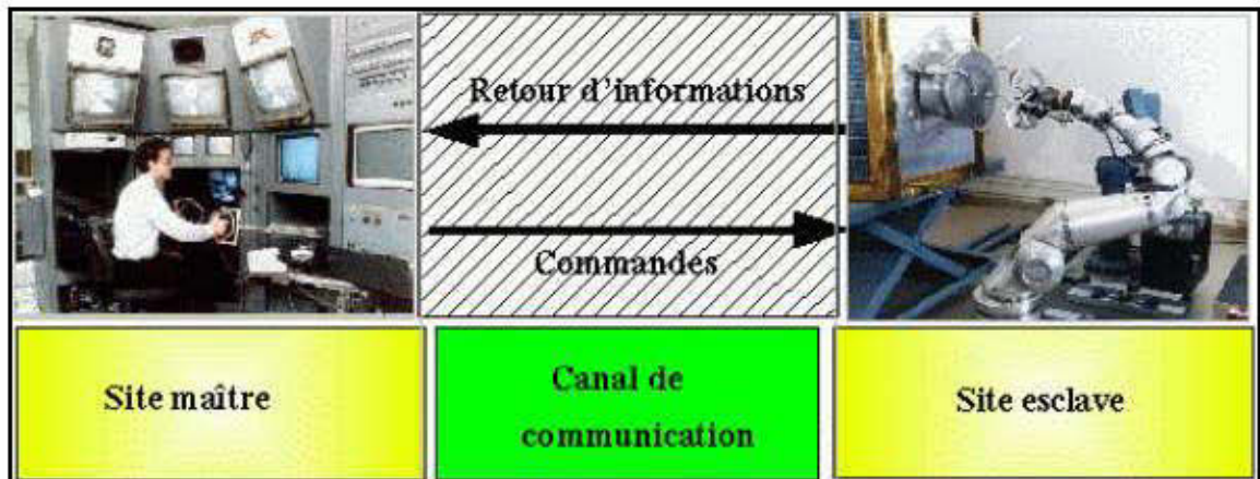
Figure 1.1: Architecture générale d'un système de téléopération [4]
