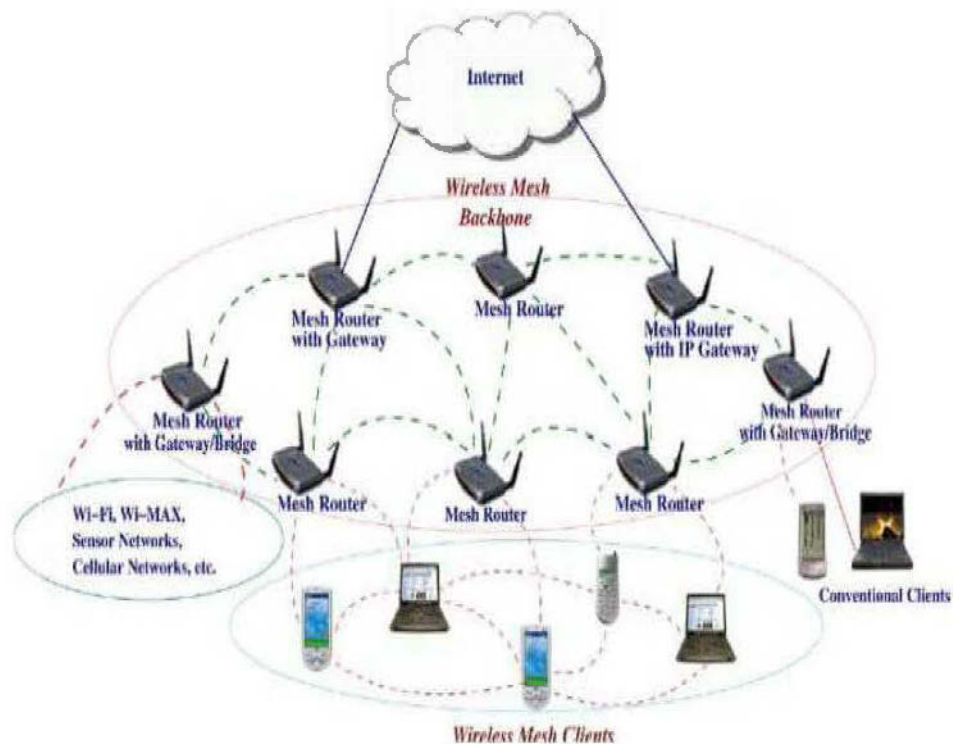
Figure 2.7 : Architecture hybride d'un réseau maillé [6]
