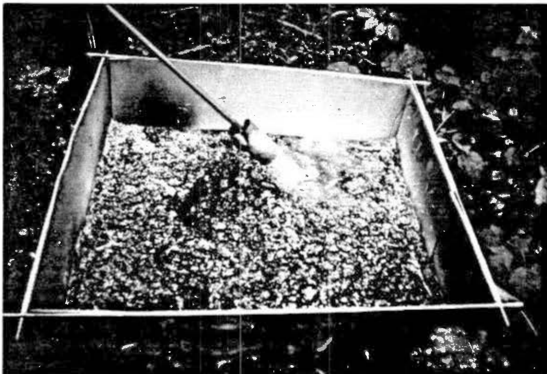
Figure 2.6 Feux de forêt simulés à l'aide d'une torche à asphalte.
