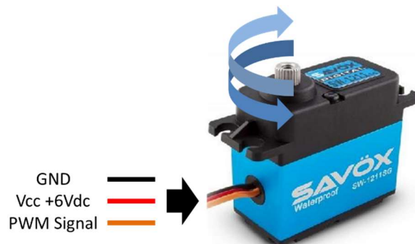
Figura 6.13. Pines de conexión actuador SAVOX SW1211SG
