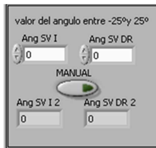
Figura 6.16. Interfaz de usuario para ajustar la posición del actuador, dentro del vehículo
