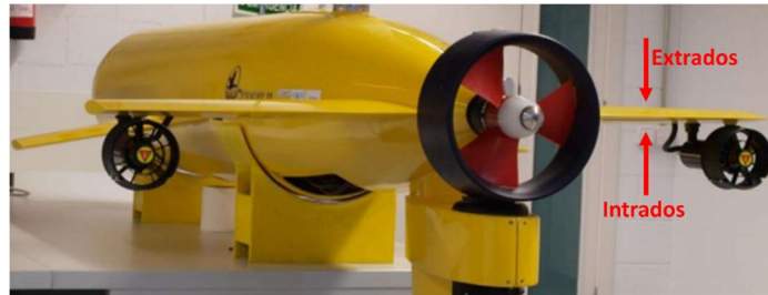
Figura 6.4. Sistema de propulsión vehículo Guanay II
