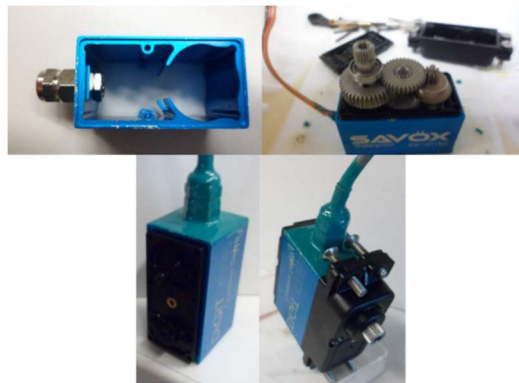
Figura 6.8. Partes del actuador SAVSW1211SG
