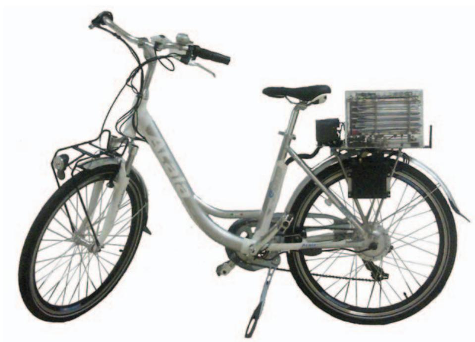
Figura 4.31: Fotografia della bicicletta a pedalata assistita sul quale è installato un modulo della batteria progettata. Per realizzare un'installazione affidabile, anche in presenza di vibrazioni, è stato realizzato un apposito portapacchi ammortizzato.
