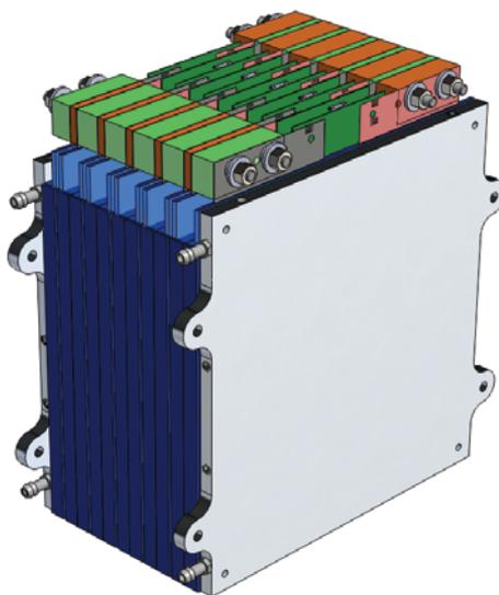
Figura 4.25: Rendering delle celle elettricamente connesse, con le CMU installate. Ai due estremi del modulo sono posizionati due dissipatori in cui circola liquido refrigerante.
