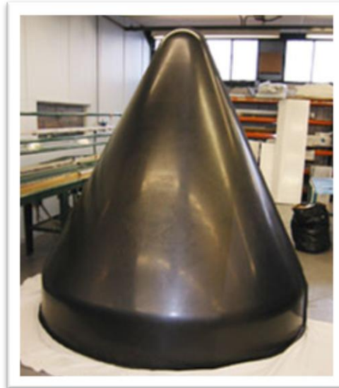
Fig. 1.13 – Nose cone in composito carbon-carbon per razzi spaziali
