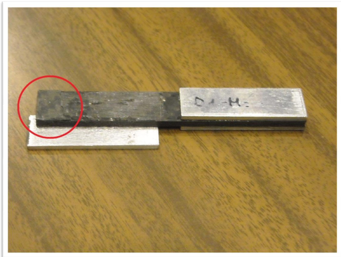
Fig. 4.5 – Scollamento dei tabs; è evidenziato il “rigonfiamento” del provino all'estremità
