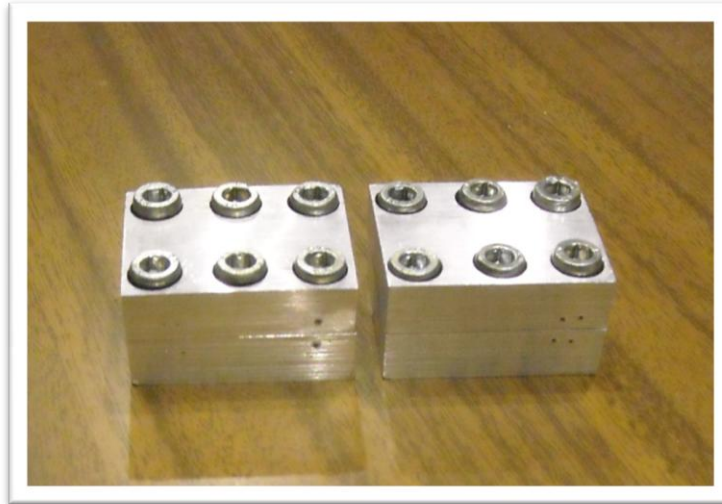
Fig. 4.12 – Piastrine in alluminio con viti a testa cilindrica con incavo esagonale
