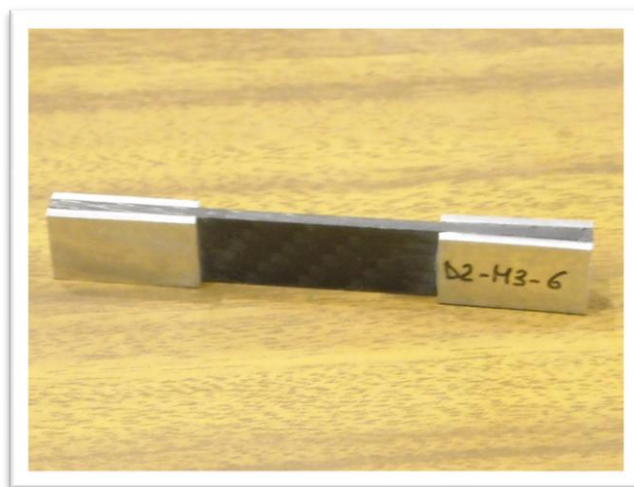
Fig. 3.1 – Provino per prove D2; i provini per le prove D1 sono gli stessi della fig. 2.10
