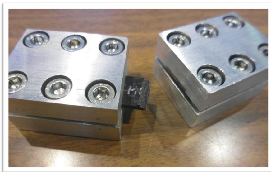
Fig. 4.13 – Rottura per delaminazione tra le piastrine del provino D1-M4-9
