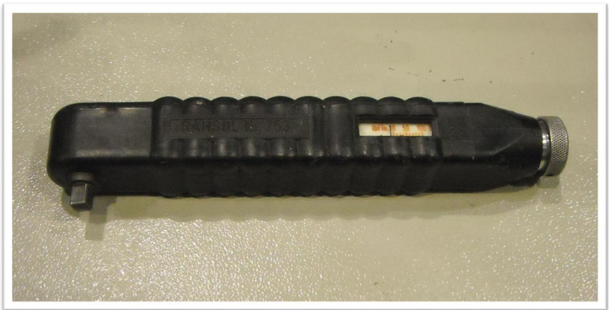
Fig. 4.14 – Chiave dinamometrica con massima coppia di serraggio pari a 20 Nm
