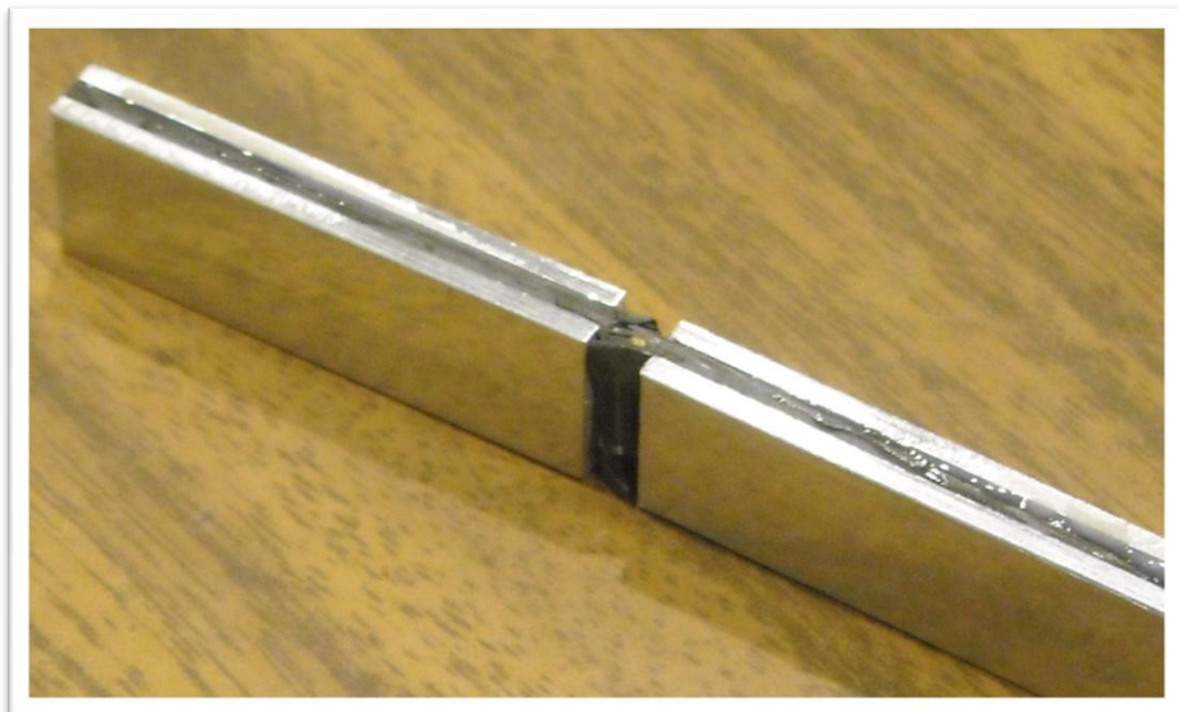
Fig. 4.17 – Tipica rottura per delaminazione
