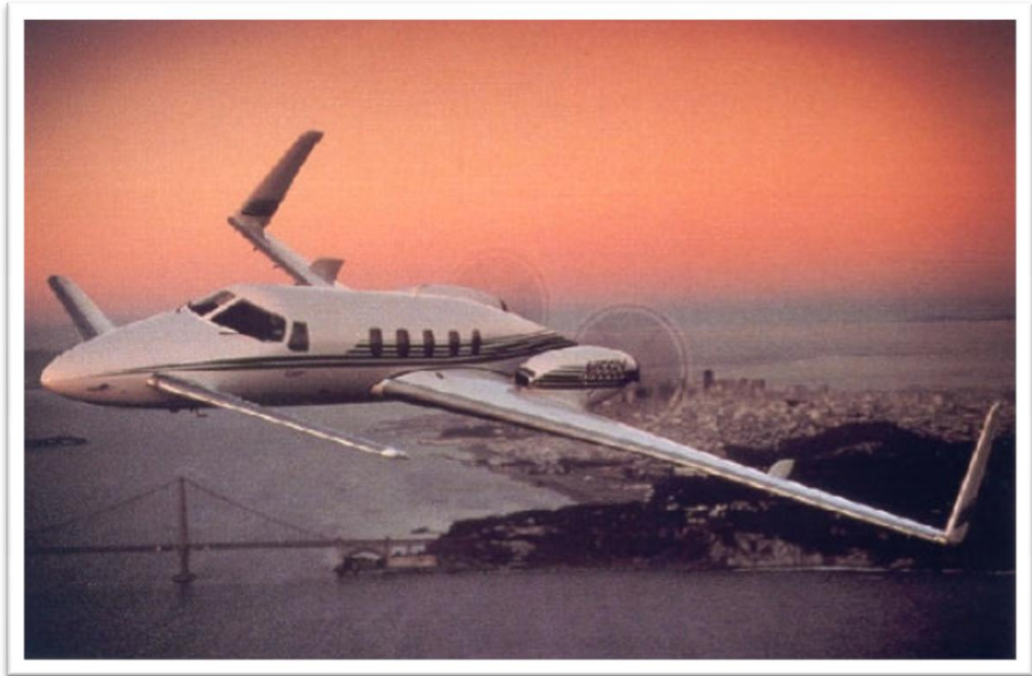
Fig. 1.12 – Il Beech Starship, la cui struttura è tutta in composito, [1]
