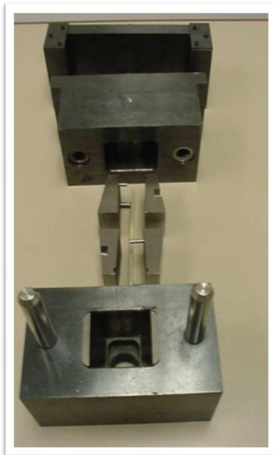
Fig. 2.7 – La IITRI fixture per la ASTM D3410, [8]
