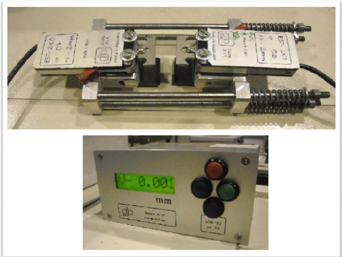
Fig. 3.9 – Estensometro e relativo trasduttore LVDT
