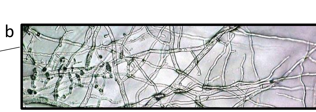
Fig. 3 a) Fungal mycelium of brown rot fungus Coniophora puteana . Sachverständigenbüro für Holzschutz, 2016. b) Fungal hyphae. Biaylock, 2010.
