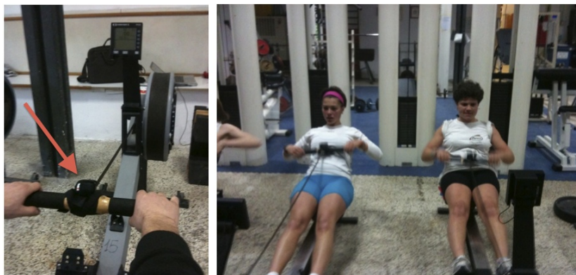
Figura 5.6.: Sinistra: montaggio del sensore sul remoergometro. Destra: esecuzione del test.
