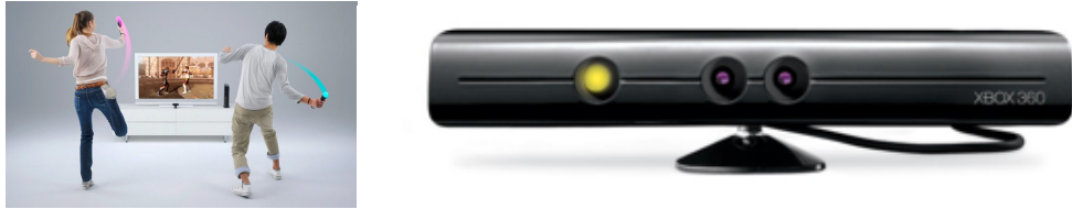
Figura 2.10.: A sinistra, il controller PlayStation Move. A destra lo speciale sensore a infrarossi del progetto Microsoft "Natal", capace di osservare il movimento libero dei giocatori in tre dimensioni.
