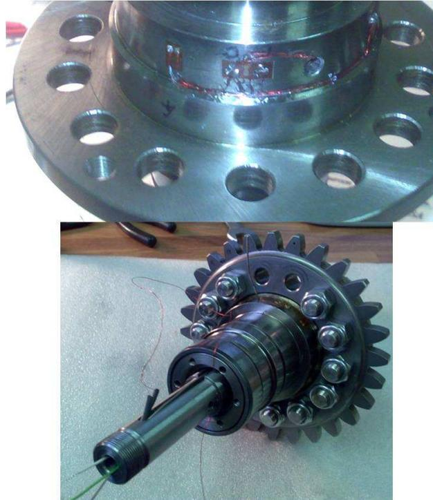
*Figura 31 - strumentazione albero mediante estensimetri*
