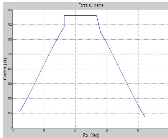
Figura 22 - Forza sul dente come funzione dell roll angle (carico massimo 500 Nm)
