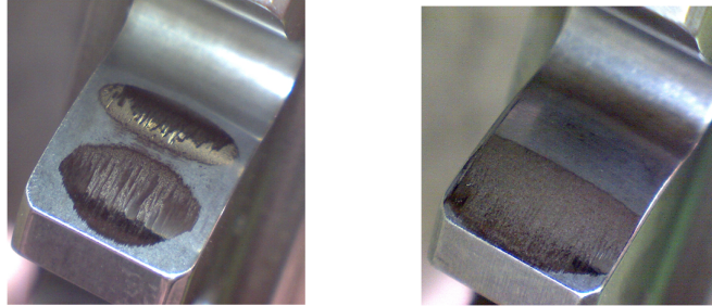
Figura 1.1: dentature danneggiate per usura adesiva
