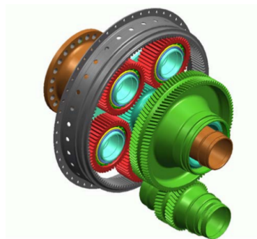
Figura 3: trasmissione di potenza del motore TP400-D6. È la più grande mai prodotta in occidente, seconda, in termini assoluti, solamente al Kuznetsov NK-12 (immagine tratta da[27])
