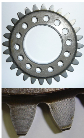
Figura 4.2: ruota dentata Z28 per prove di scuffing e particolare dell'asimmetria del fianco dei denti
