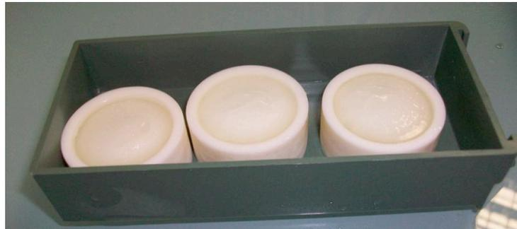
*Figura 3.23: Campioni di idrogel di PVA a otto cicli di Freezing-Thawing*
