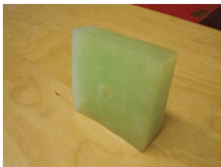
*Figura 2.9: Phantom di PVA che consiste di tre differenti tessuti: due blocchi esterni che rappresentano il tessuto adiposo e fibrogliandolare del seno, e un blocco interno cilindrico per simulare un tumore*
