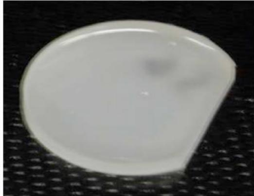
*Figura 2.7: Phantom di microsfele di silice in matrice siliconica (Sylgard 184)*
