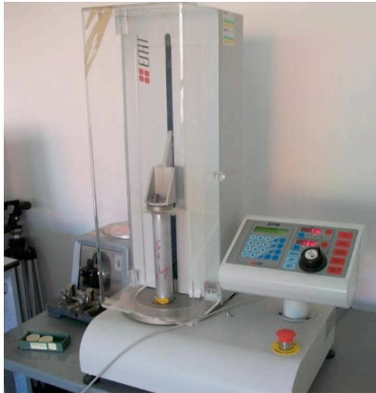
*Figura 4.1: Macchina ESAT utilizzata per le prove di compressione*
