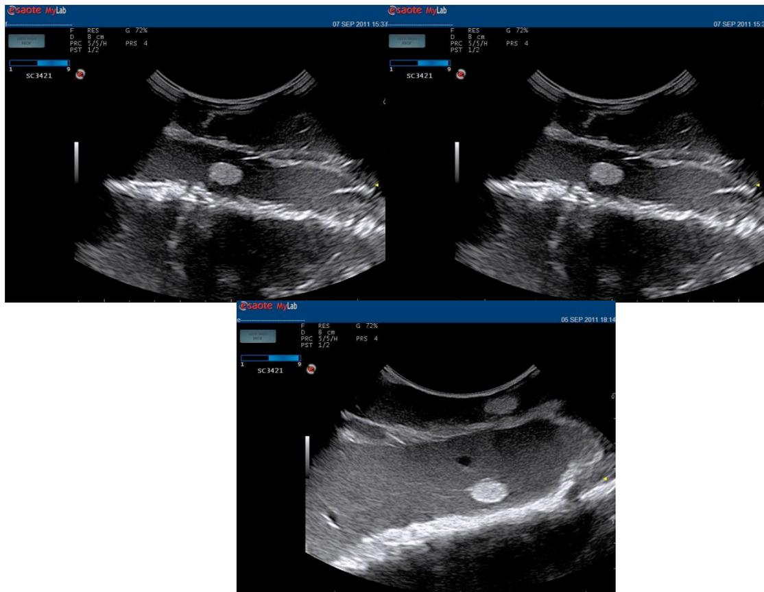
*Figura 4.17: Immagini ecografiche del phantom di fegato acquisite in varie zone: a) immagine di riferimento per i provini di Sylgard e di DS FX-Pro; b) immagine di riferimento per i provini di PVA; c) immagine di riferimento per i provini di Ecoflex e DS Medium*
