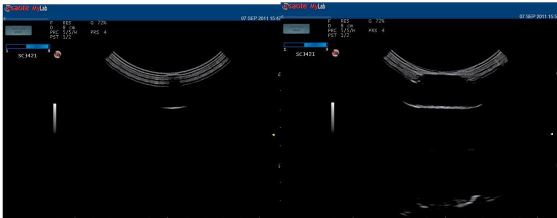
*Figura 4.18: Immagini ecografiche del campione di Sylgard (a destra con l'ausilio del gel ecografico e a sinistra senza); in entrambi i casi può notare che non si ha passaggio del segnale attraverso il campione*
