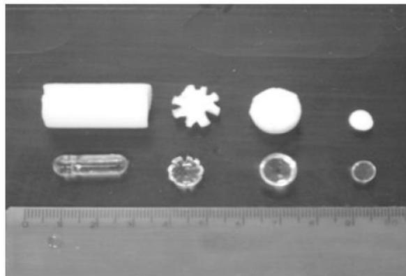
*Figura 2.11: Lesioni simulate realizzate con PAA (sopra) e silicone (sotto):
