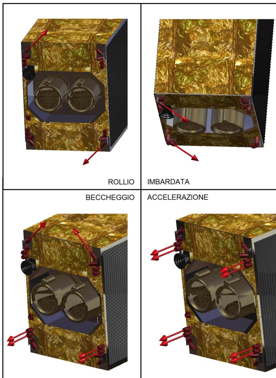
Figura 62: Modi di attivazione dei propulsori per il controllo del veicolo
