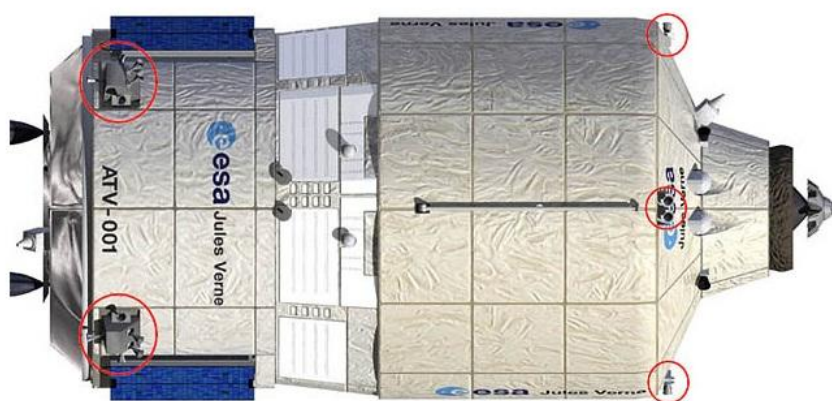
Figura 4: Disposizione dei propulsori di assetto dell'ATV
