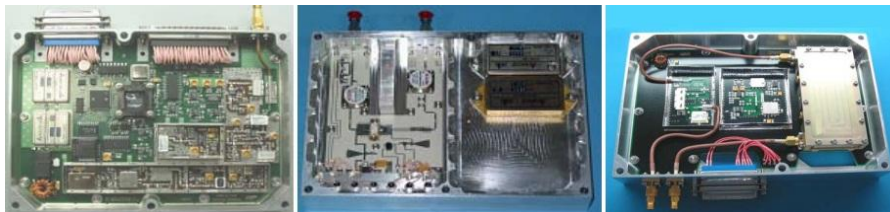
Figura 68: Elettronica di comunicazione su banda S – Da sinistra: trasmettitore, amplificatore, ricevitore [149,150,151]
