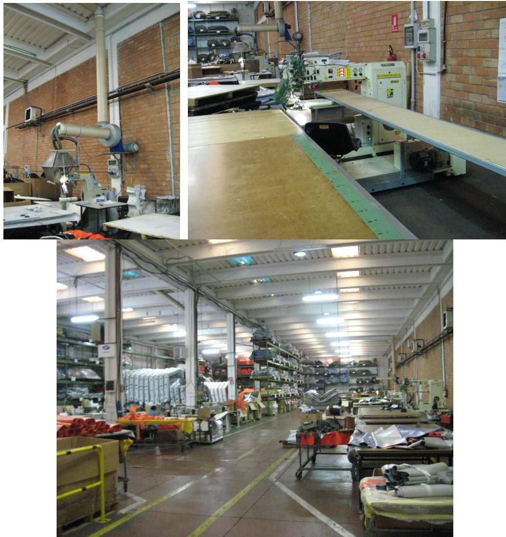
Figura 48 macchina a soffio, macchina a cuneo, ed estratto del reparto di cucitura, saldatura a caldo e gonfiaggio archi.
