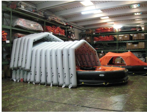
Figura 47 deposito degli archi che affrontano il test di tenuta.
