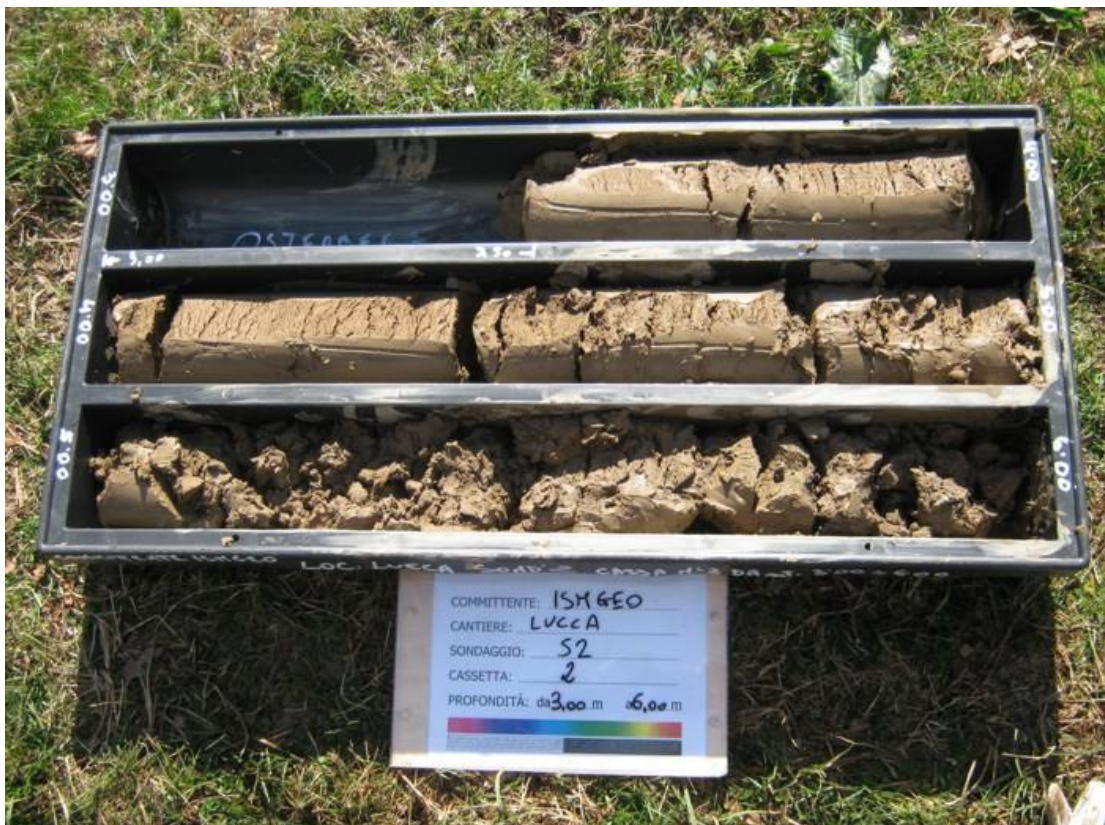
Figura 25. Risultato di un sondaggio
