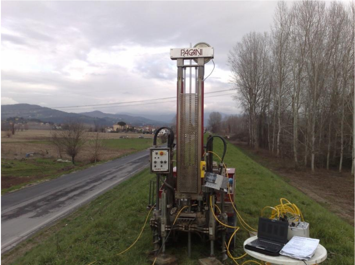
Figura 30. Realizzazione di una prova CPTu
