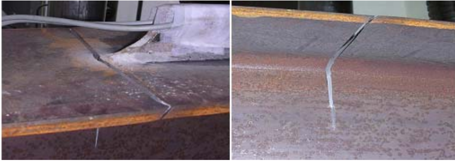
Fig. 7.4 – Viadotto Sesia: modalità di rottura per fatica del provino ° 1.
