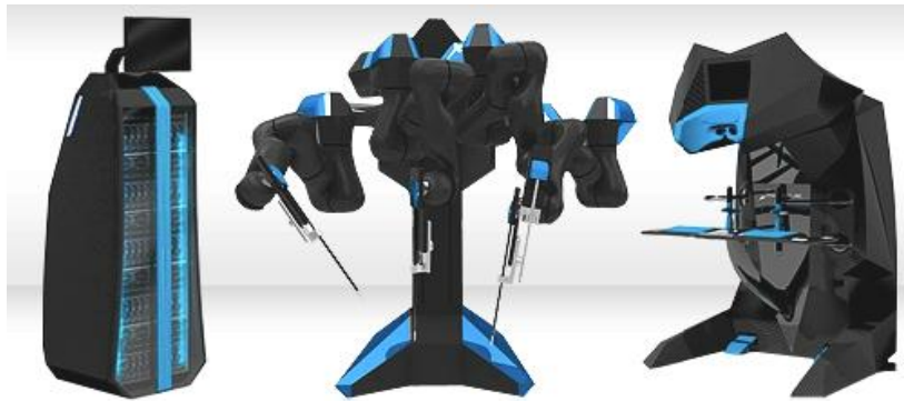
Figura 2.4 – Prototipo di Amadeus surgical system (migliorata articolazione bracci, potenziato sistema visivo e introduzione feedback tattile)
