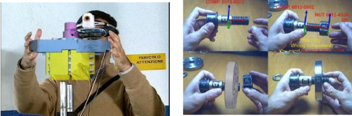
Figura 3.1 Applicazioni di realtà aumentata nell'assemblaggio di componenti meccanici
