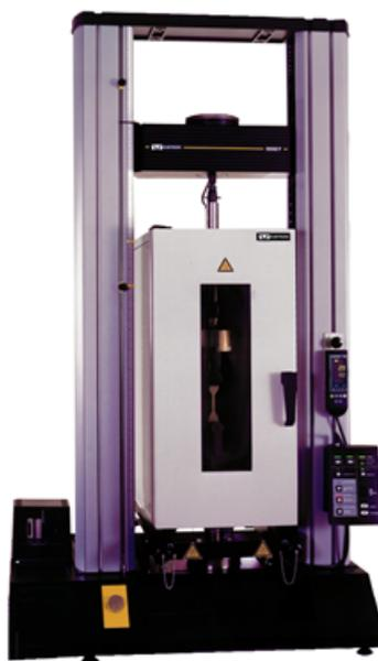
Figura 2.12: Camera climatica servo-idraulica di ultima generazione
