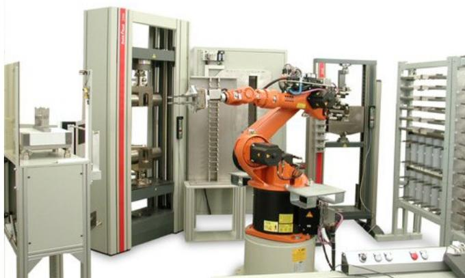
Figura 3.2: Macchina di prova completamente automatizzata
