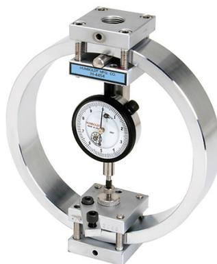
Figura 3.7: Anello dinamometrico
