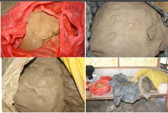
Gambar 2. Tanah yang telah diolah manual maupun mesin siap dibentuk menjadi sampel keramik
