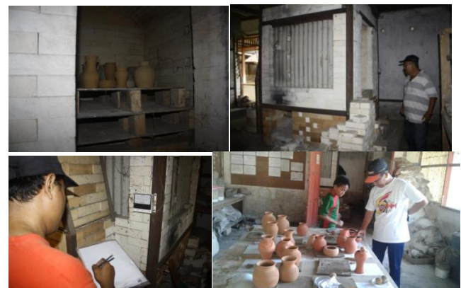
Gambar 4. Proses pembakaran dan memeriksa hasil pembakaran
