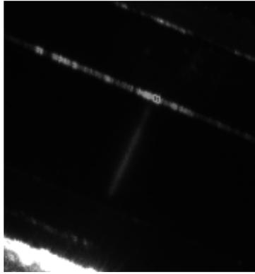
**Figura 3.10:** Immagine di scattering Thomson presa ad energie dell'impulso  $< 0.3 J$  in cui si osserva solo la luce diffusa di autoemissione di plasma (ricombinazione atomica). Grazie alla lunga focale già a queste energie la ionizzazione avviene su tutti i  $4 mm$  del getto gassoso.
