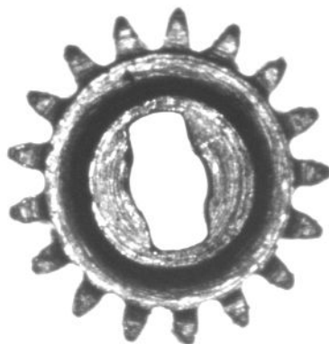
A. figura 2.10: La ruota dentata a 17 denti in ottone.
