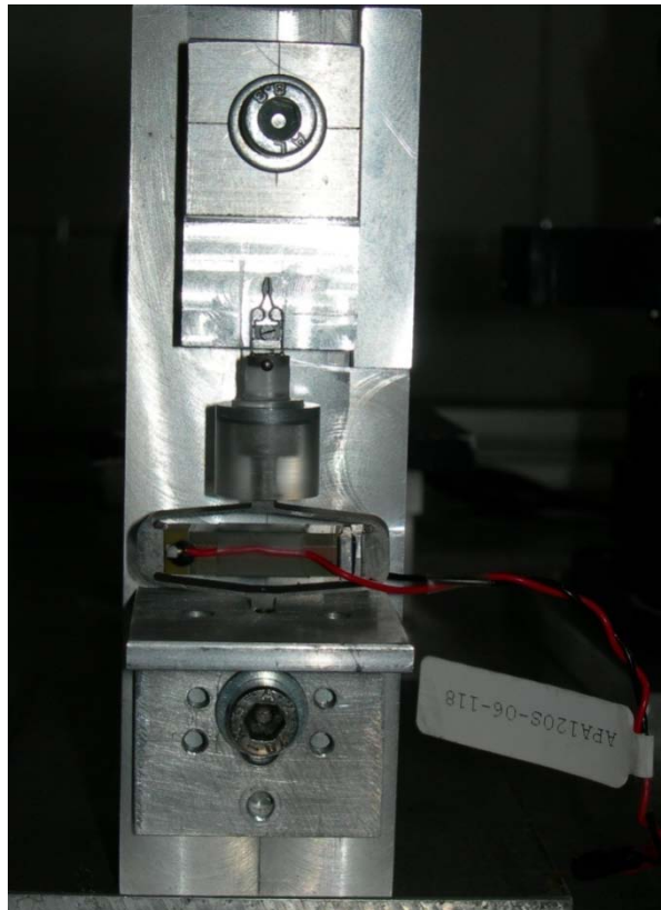
Fig. 3.18 Ingrandimento del collegamento Gripper – Giunto in plexiglass
